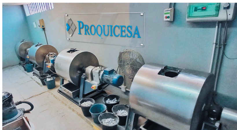
Figura 1. Planta piloto de PROQUICESA en la que se reproducen a escala los cementos de los clientes.
